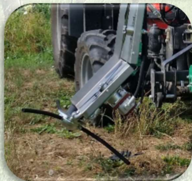
Coltello sylvose con motore idraulico Inc.(45°)
