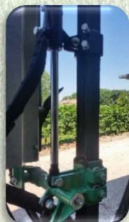
Regolazione dell'altezza del topping idraulica 40cm
