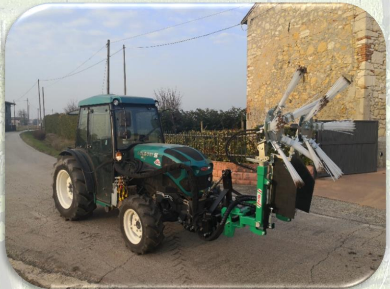
Andanatrice per radunare i residui delle potature nell'interfila dei frutteti e vigneti, regolabile idraulicamente e disponibile in 4 versioni ad un braccio o due braccia per filari fino a 5Mt. di larghezza
