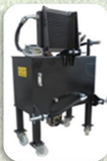
Impianto Idraulico 50 LT Portata 40 LT/MIN
