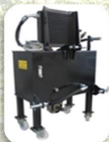
Impianto Idraulico con doppia pompa 25+11cc
