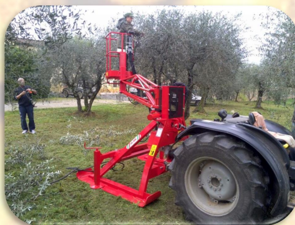
TR1K utilizzato per la potatura su impianto di ulivo basso
