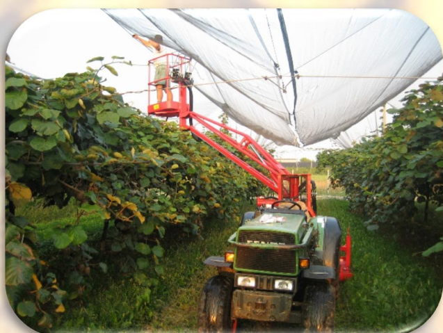
TR1K utilizzato per l'apertura e chiusura delle reti anti grandine
