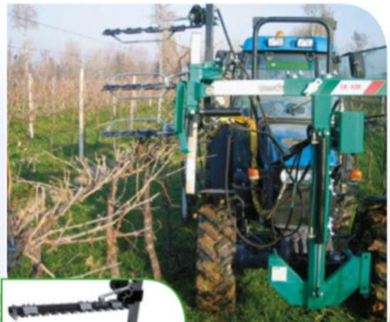
Sistema a due o tre barre per potatura a secco su contropalliera con rientro idraulico-meccanico.
