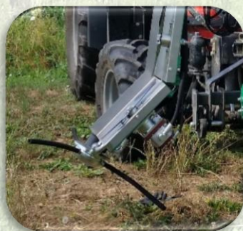
Coltello sylvoz con motore idraulico Inc.(45°)
