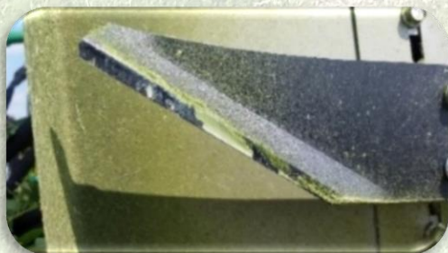
Coltelli autopulenti in acciaio speciale anti incrostamento
