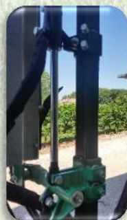
Regolazione dell'altezza del topping idraulica 40cm
