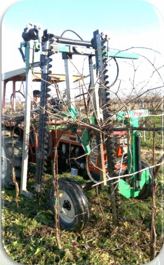
CL200 scavallata adattabile per la potatura della cortina semplice con lame monolama autoaffilanti
