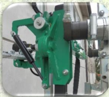
Barra scavallante disponibile da Mt 1.80 o Mt 2.10 monolama o bilama con molla anti urto
